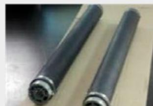
Bild 3: Durch Öl und ausgetragenes Absorptionsmaterial blockierte Belüfterkerzen
