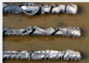
Bild 2: Belüfterkerze durch chem. Reaktion mit Öl zerstört
