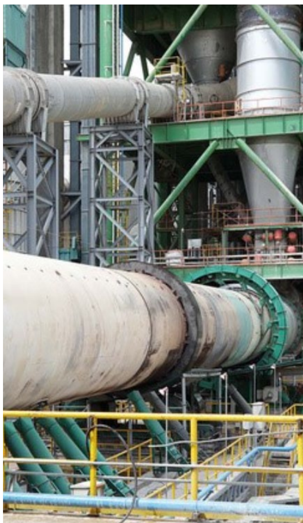
Der Brennprozess im Drehofen macht 90 % des gesamten Energiebedarfs eines Zementwerks aus.
