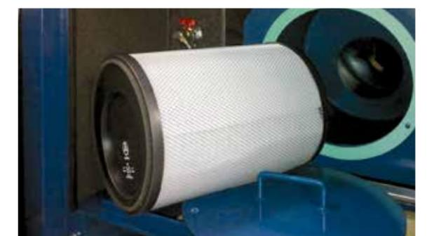
*Einfache und schnelle Entnahme des Ansaugfilters*
