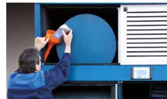
*Problemloses Befüllen des Verdichters mit Schmieröl*
