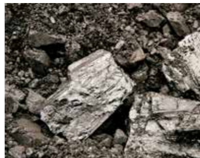
Bild 2: Mit Öl kontaminiertes Schüttgut aus dem pneumatischen Förderprozess
