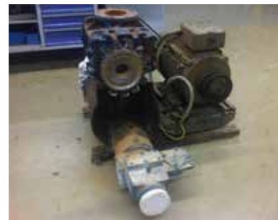
Bild 3: Aufgebrannte Druckluftanlage nach Funkenerzeugung in der Gebläsestufe
