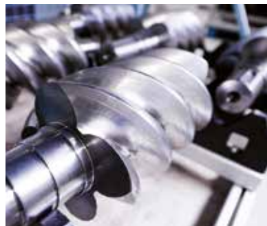
Bei höheren Drücken überlegen: Rotorprofile von Schraubenverdichtern
