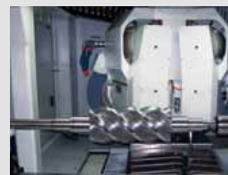
Die neue Danobat schleift Verdichterroture auf den Mikrometer genau.
