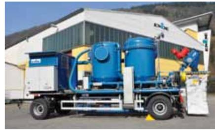
renzdrucküberwachtes Drehkolbengebläse der Baugröße GM 35S. Es schaltet bei einem etwaigen Filterdurchschlag automatisch ab. Die voll automatisierte Staubsauganlage wird über eine elektrische Steuerung mit SPS betrieben.
