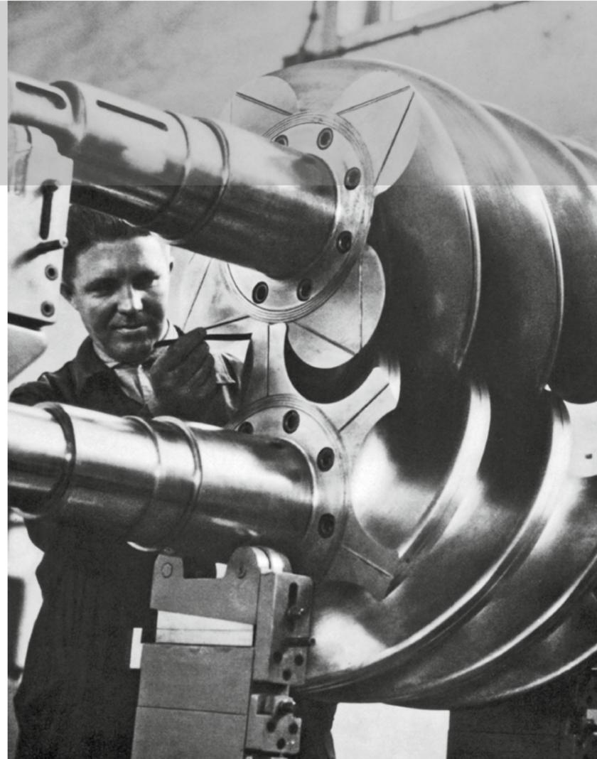
Ein AERZEN Arbeiter begutachtet Schraubenverdichter-Rotoren in der Prüfvorrichtung.
