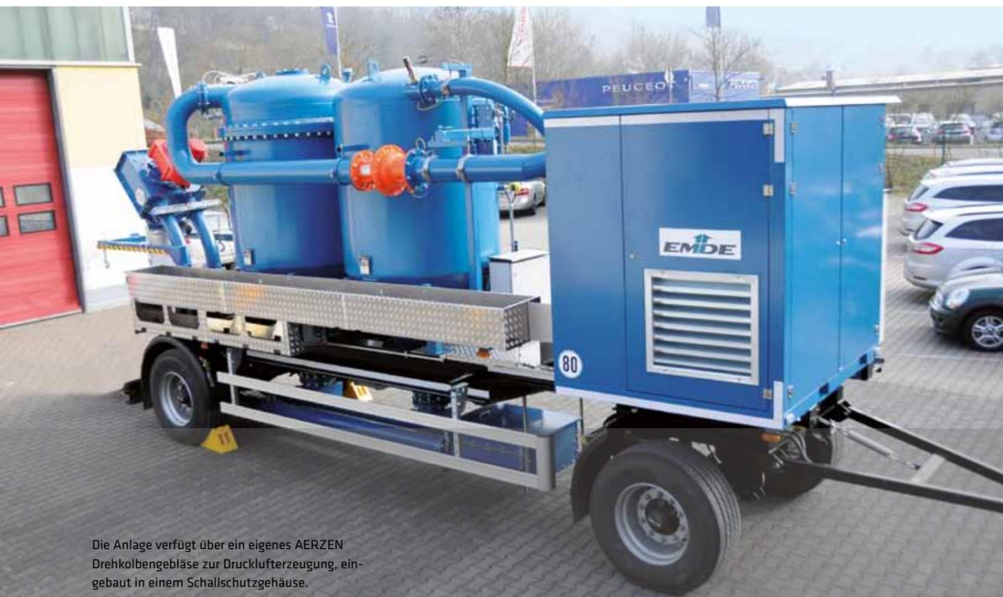
Die Anlage verfügt über ein eigenes AERZEN Drehkolbengebläse zur Druckluftherzeugung, eingebaut in einem Schallschutzgehäuse.
