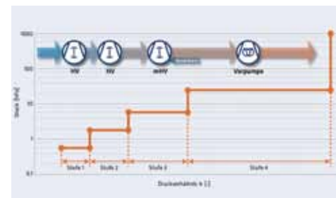
Diagramm eines 4-stufigen Pumpstandes: Stufe 1 und 2 mit HV Gebläse
