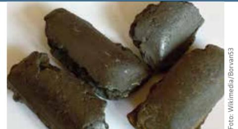
Mit dem Direktreduktionsverfahren werden Eisenschwammbricketts erzeugt.
