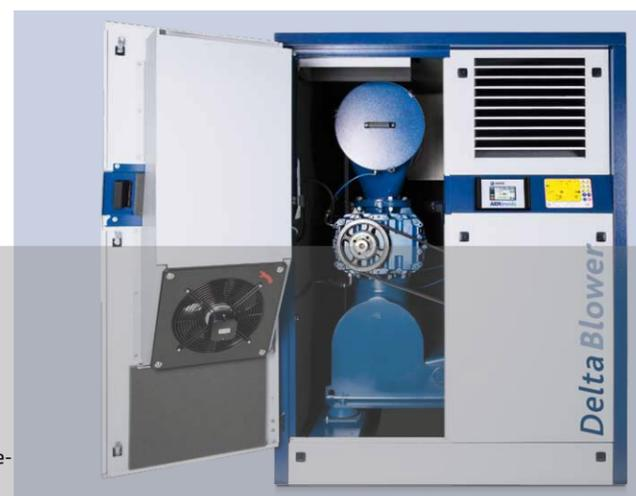
platzsparende Aufstellung und benötigt weniger Fläche im Maschinenraum. Gemäß dem AERZEN Environmental Concept erreichen alle Gebläse die Ölfreiheit Klasse 0 nach ISO 8573-1, sind zu 100 Prozent absorptionsmittelfrei und brauchen erst nach 16.000 Betriebsstunden einen Ölwechsel. Standardmäßig werden energieeffiziente Motoren der Klasse IE3 eingesetzt, die Ansaugung erfolgt auf der kalten Seite des Aggregats.
