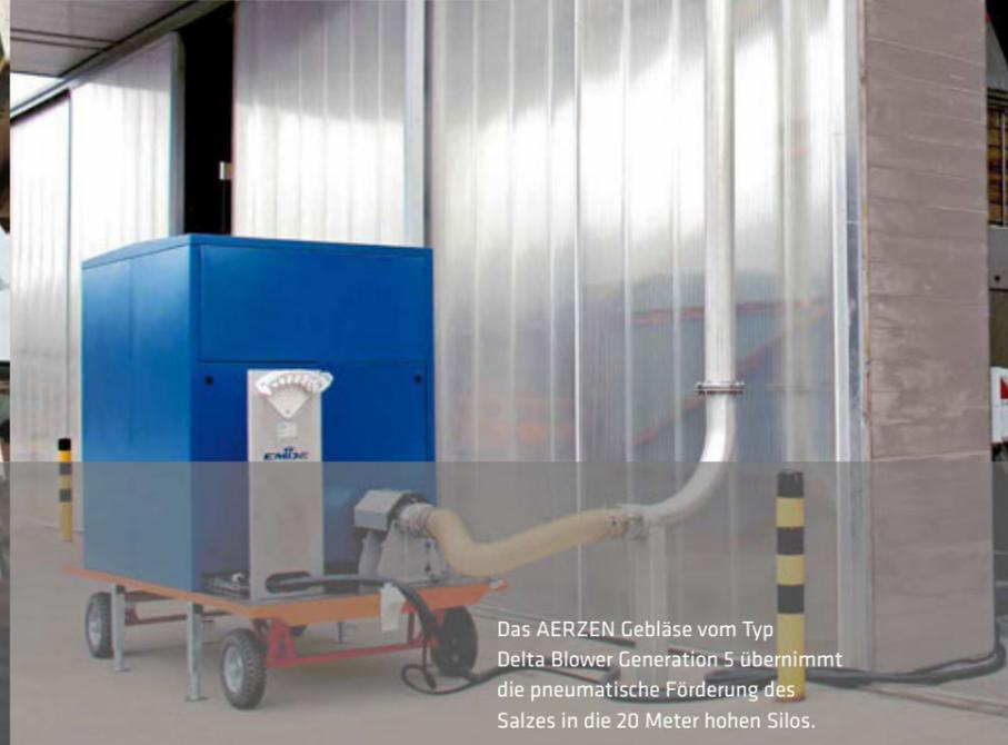
Das AERZEN Gebläse vom Typ Delta Blower Generation 5 übernimmt die pneumatische Förderung des Salzes in die 20 Meter hohen Silos.
