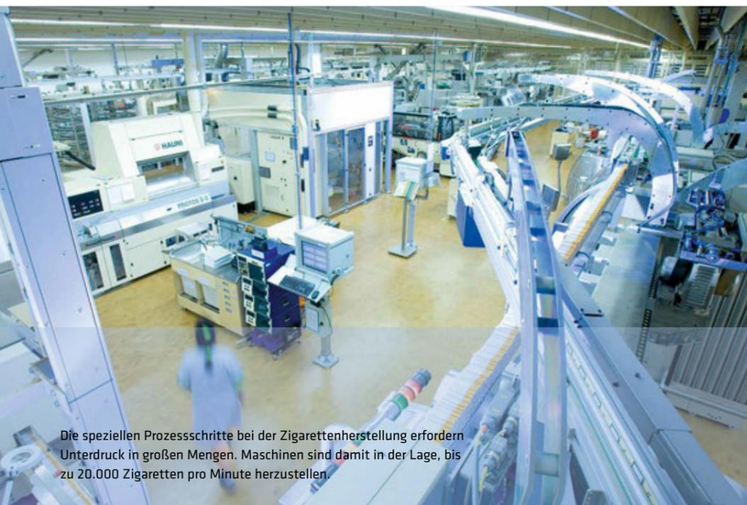
Die speziellen Prozessschritte bei der Zigarettenherstellung erfordern Unterdruck in großen Mengen. Maschinen sind damit in der Lage, bis zu 20.000 Zigaretten pro Minute herzustellen.
