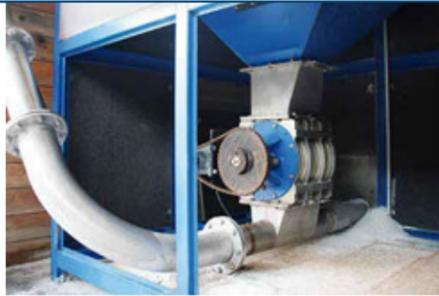
Im Inneren des Einfülltrichters sorgt eine Zellenradlschleuse für die richtige Dosierung des Salzes und eine konstante Durchsatzleistung. Die Produktzuführung wurde von Emde strömungstechnisch optimiert.
