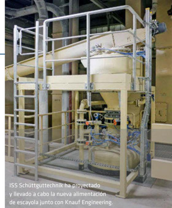
ISS Schüttguttechnik ha proyectado y llevado a cabo la nueva alimentación de escayola junto con Knauf Engineering.
