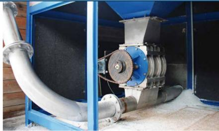
Dentro de la tolva de llenado, una esclusa de rueda celular se encarga de la dosificación correcta de la sal y un rendimiento de paso constante. Emde optimizó el flujo de la alimentación de producto.
