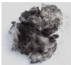
...instalación de aire comprimido calcinada después de generarse chispas en la etapa de soplante
