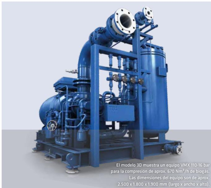
El modelo 3D muestra un equipo VMX 110-16 bar para la compresión de aprox. 670 Nm<sup>3</sup>/h de biogás. Las dimensiones del equipo son de aprox. 2.500 x 1.800 x 1.900 mm (largo x ancho x alto).
